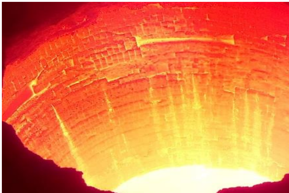
Figura 2. Ferro-gusa penetrado nas frestas dos tijolos do revestimento refratário
