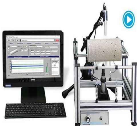
Figura 14. Esquema do aparato para medição do módulo elástico.
